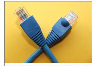
**cavi UTP con connettore RJ-45**
