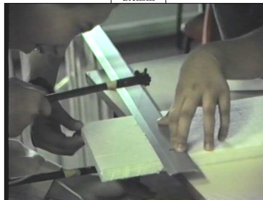
Da una fascia di polistirolo vengono ritagliati i singoli pezzi. Viene utilizzata una vecchia taglierina con un filo caldo che fonde il polistirolo.
