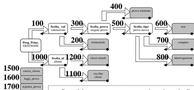
grafico del progetto con una prima ipotesi di collocazione delle procedure. Se necessario, l'ordine RENUM permetterà di modificare i numeri di linea
