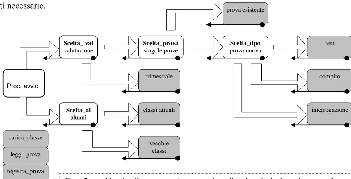
Il grafico evidenzia gli spostamenti tra procedura d'avvio principale e altre procedure nel programma presentato precedentemente. E' importante ricordare che, al termine di ogni procedura, l'esecuzione ritorna alla procedura di provenienza. A parte sono collocate alcune *procedure comuni* destinate ad essere chiamate in più occasioni.
